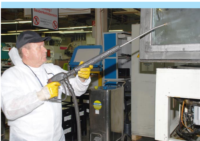
Einer der Vorteile der Dampfreinigung: Es entstehen keine Wasserlachen und die gereinigten Teile sind nahezu sofort trocken.
