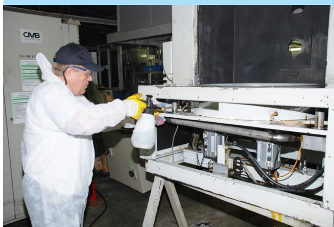
Bei besonders hartnäckigen Fetten wird vor der Dampfreinigung ein Grundreiniger auf die Verschmutzungen aufgesprüht. Dies ist jedoch nur in Ausnahmefällen notwendig.
