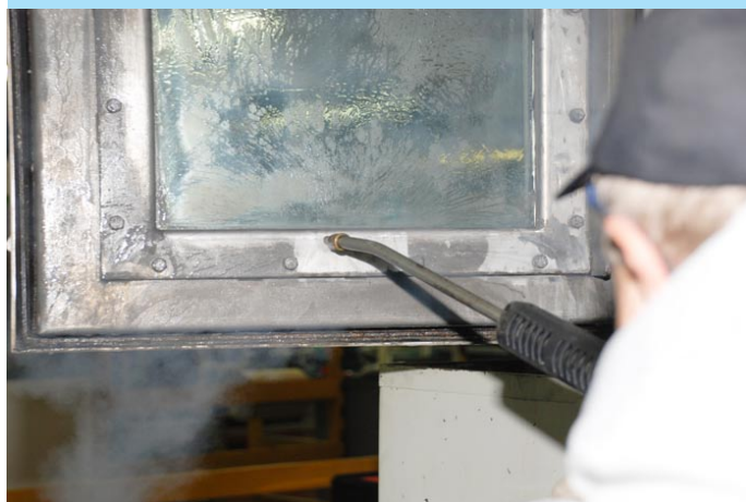
Minimaler Wasserverbrauch - große Wirkung: Gut zu sehen sind die von Bruno Mazurek bereits gereinigten und die dazwischenliegende ungereinigte Fläche. Der 20 Liter fassende Wassertank reicht - je nach Verschmutzungsgrad - etwa für eine Stunde Arbeit.
